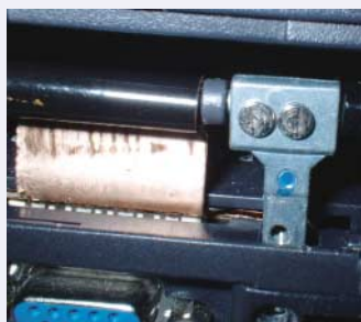
Reparatur zu teuer, da hat der Kunde das Scharnier seines Dell-Notebooks selbst gemacht (links). Rechts ein Original-Scharnier aus Druckguss.
